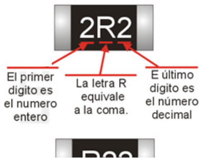
Fig.8.3.1 Código de 3 dígitos para resistores menores a 10 Ohms
