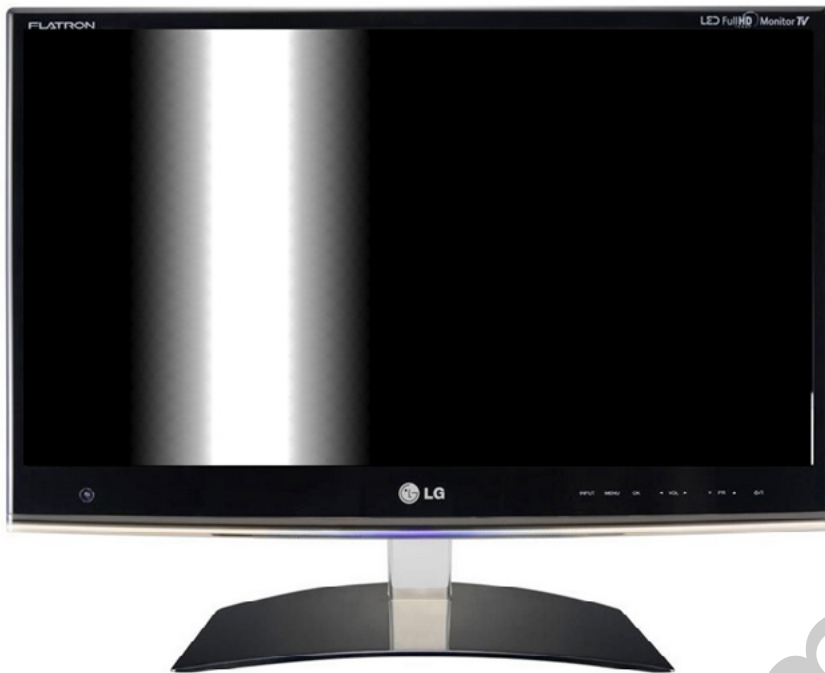
Fig. 7.5.5 Iluminación de la segunda cadena de LEDs
