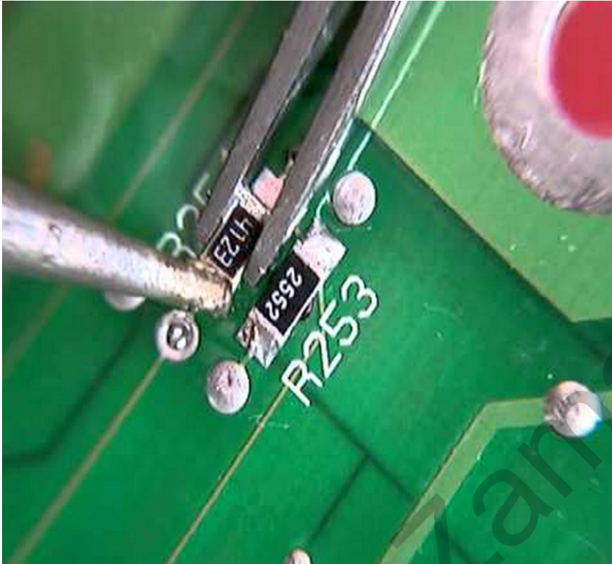
Fig.8.2.4 Disipación forzada al desoldar con una Bruselas
