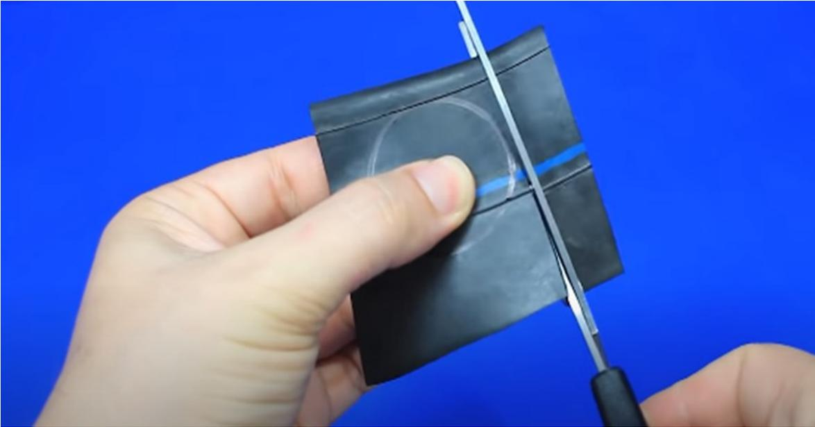
En esta fase cortemos un trozo de goma del tamaño del interior de la tapa, del tapón del tubo de PVC, que anteriormente ya habíamos atornillado al eje del motor.
