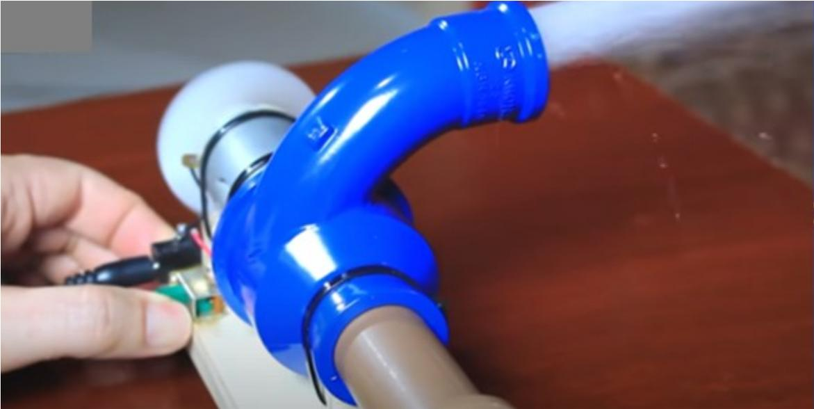
Finalmente pintaremos con spray y probaremos la bomba conectándola a una tubería PVC introducida en un tanque, encendemos y tendrá la suficiente fuerza para expulsar el agua.
