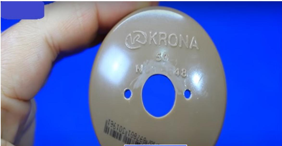
Abriremos tres orificios con el mini taladro, uno para el eje del motor y los dos equidistantes con la intención de atornillar el motor a la tapa. Los orificios deben quedar como se muestra en la imagen.
