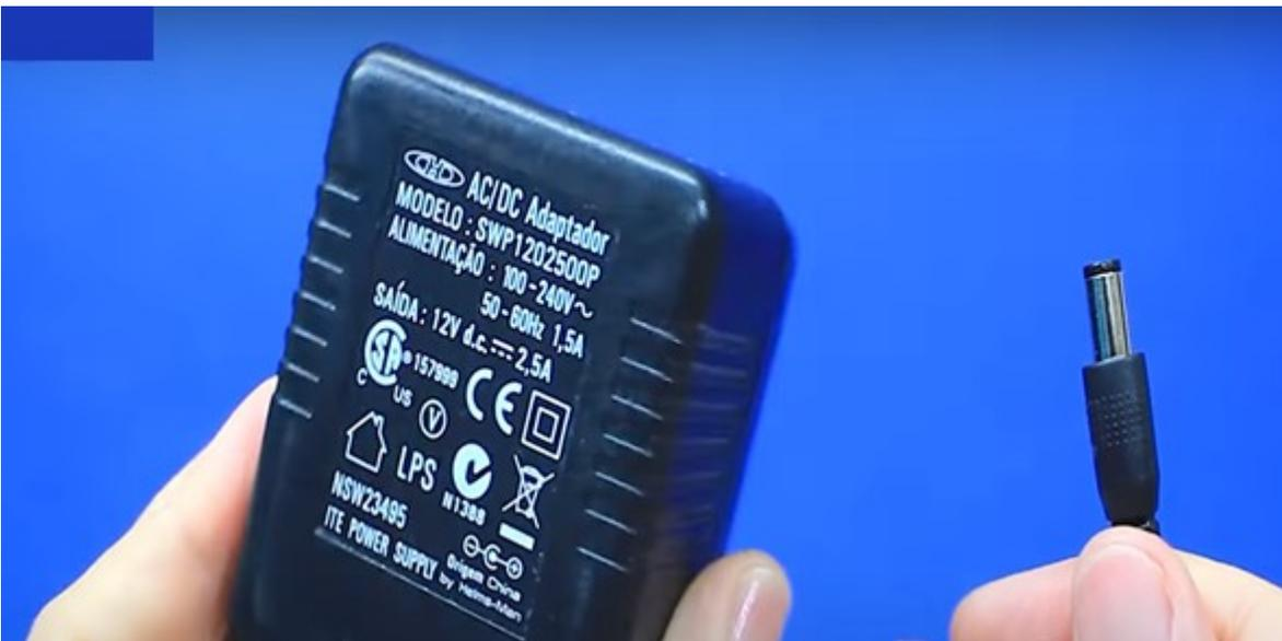
Nuestra fuente de alimentación será un transformador, una fuente de corriente DC de 12 V que finalmente acoplaremos al rotor de nuestro motor de 12 V.
