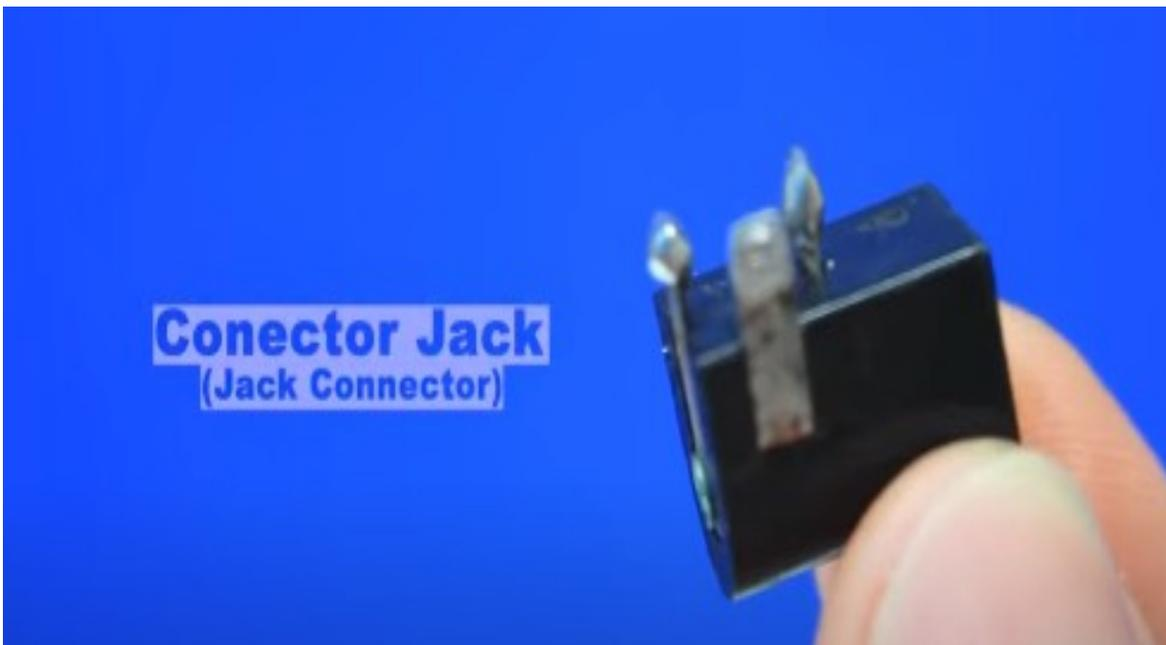
Colocaremos el Interruptor LCD el cual conectaremos el positivo al conector Jack y del otro terminal del interruptor a uno de los terminales del motor y del otro terminal del motor al conector Jack
