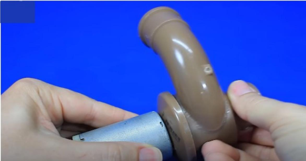
Esto nos permitirá mover el agua, a través de nuestra tubería que acoplaremos a la carcasa que construimos con PVC, que concentra el agua y la dirigirá, a medida que el impulsor la recoge y la empuja hacia afuera, por tanto, tenemos una entrada de succión y una salida de descarga
