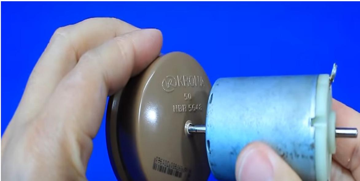
Con ayuda del motor marcaremos en el tapón el área donde se abrirán los orificios.
