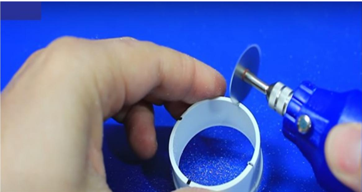
Con el resto de la tapa de tubería, la dividiremos en cuatro partes iguales y cortaremos con el Dremel.
