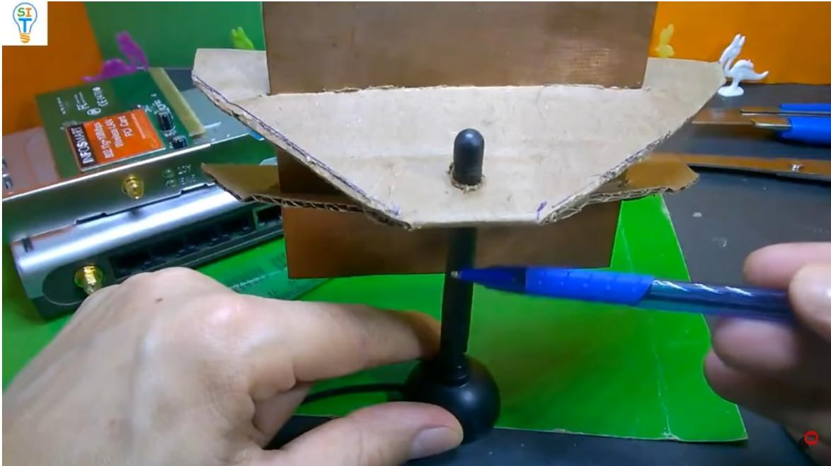
Ahora le explico este tipo de antena es dipolo y como he dicho antes lo que estamos realizando es colocarle una placa reflectora que nos va ayudar a amplificar, porque esta antena sola no tiene el alcance suficiente sin una placa como esta, este tipo de antena es omnidireccional significa que funciona en 360 grados
