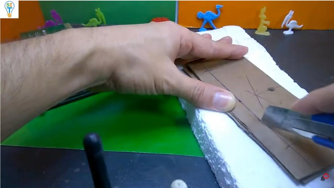
para no dañar la mesa, porque vamos a usar el exacto, trazamos exactamente la línea hasta las marquitas del tamaño de la placa y cortamos el cartón
