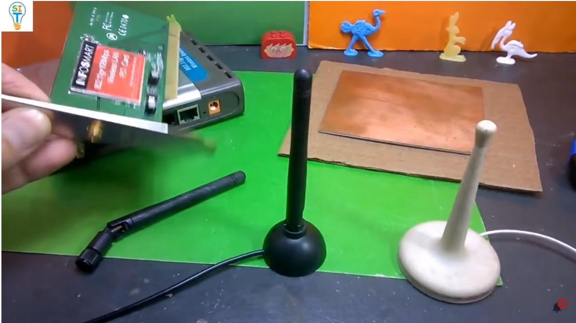
se conectan aquí a través de este conector o con un Router o access point, básicamente traen estas antenas cuando las compras, son buenas antenas y muy usadas ya que son dipolo omnidireccional.
