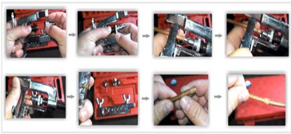
Figura 16. Expansión con mordaza y herramienta de expansión.
