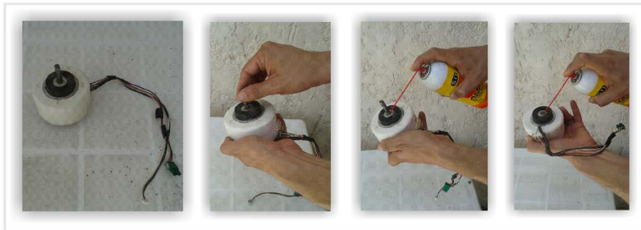
Figura 61. Chequeo y lubricación de motor de turbina.
