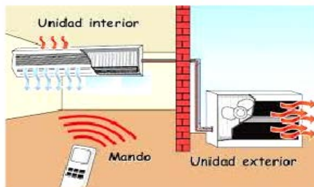
Figura 1. Partes de un aire acondicionado Split.
