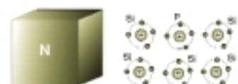
Cuando se introducen impurezas de Níquel en un cristal semiconductor, se aumenta el número de electrones relativo
