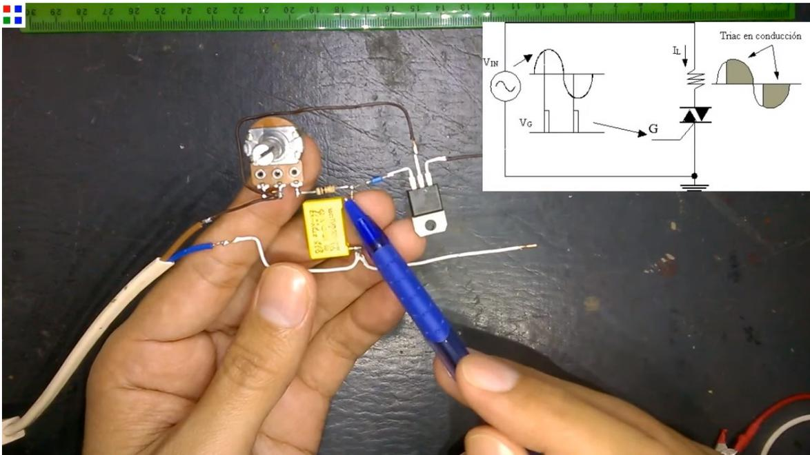
y ese tiempo lo va a controlar tanto este capacitor, el diac y el potenciómetro, entonces es así de sencillo el funcionamiento.
