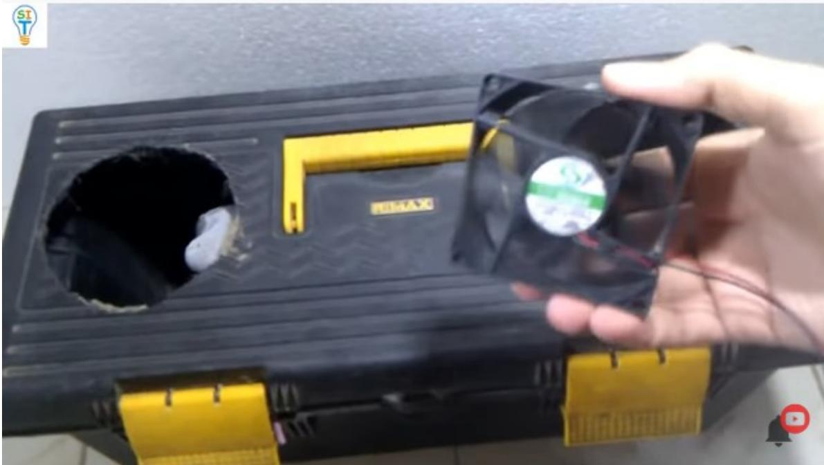
Por el momento para la explicación se va a utilizar el ventilador más grande, se coloca por una de las aberturas el ventilador que nos va a impulsar el aire y por la otra abertura va a salir el aire más frío que el que entra.
