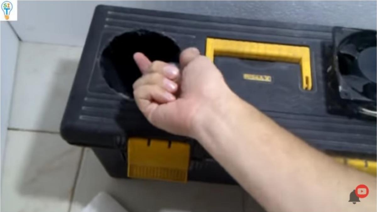
En este caso usamos un ventilador extractor de 115V, 0,22mAh, pero si no se tiene uno así se puede utilizar uno de 12V, que son los que se le sacan a las fuentes de poder viejas de Pc las cuales lo traen en la parte de atrás, la diferencia es que impulsa menos aire.
