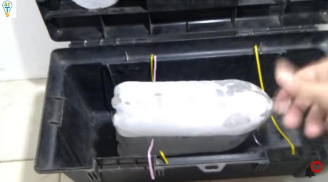
Entonces lo que vamos a hacer es ponerlo en funcionamiento por dos horas para ver cuánta agua se puede recoger y lo podemos comparar con lo que produce un aire de 2000BTU; para darnos cuenta que este aire realmente va a funcionar porque va a extraer el agua que tiene el ambiente y es lo que hace básicamente un aire acondicionado.
