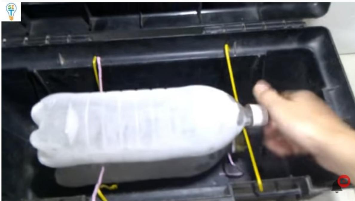
Es muy importante que no se toquen entre ellas o que queden algo separadas, y que ambas queden suspendidas verificando que la caja pueda cerrarse correctamente.
