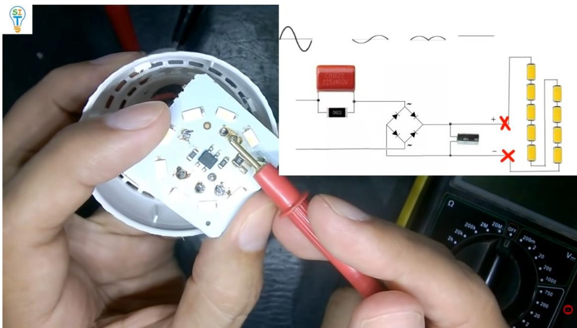
entonces deberíamos medir el voltaje que está llegando a todos los leds que están en serie, nosotros necesitamos un punto para medir, sería justamente en los extremos de este capacitor, se lo estoy diciendo porque allí es donde voy a medir ya tengo aquí conectado y voy a hacer la medición.
