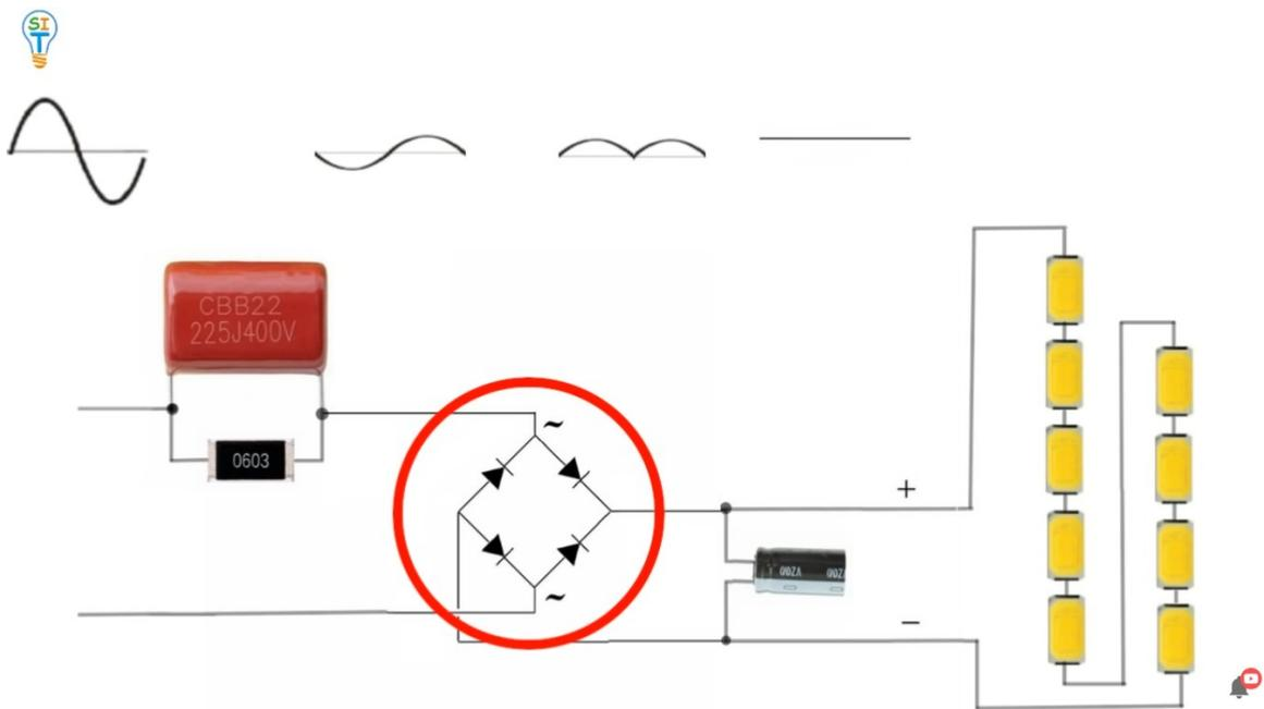
puente rectificador va a rectificar la señal, la va a dejar en un solo sentido y por último la otra etapa que se tiene es la del filtrado que se hace con otro capacitor, pero este capacitor trabaja de forma diferente
