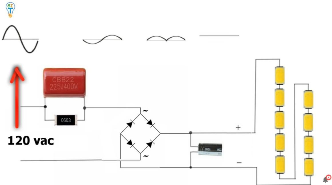
Luego la siguiente etapa es un capacitor no polarizado que es el encargado de reducir básicamente el voltaje de 120 voltios a un voltaje mucho menor
