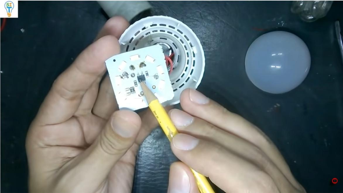
entonces fíjense lo siguiente, lo primero que hay que analizar es qué estos diodos consumen voltaje DC por separado entonces aquí viene la parte interesante cada diodo de estos lo que consume es 3 voltios más o menos DC nosotros tenemos por ejemplo en esta placa 9 diodos leds
