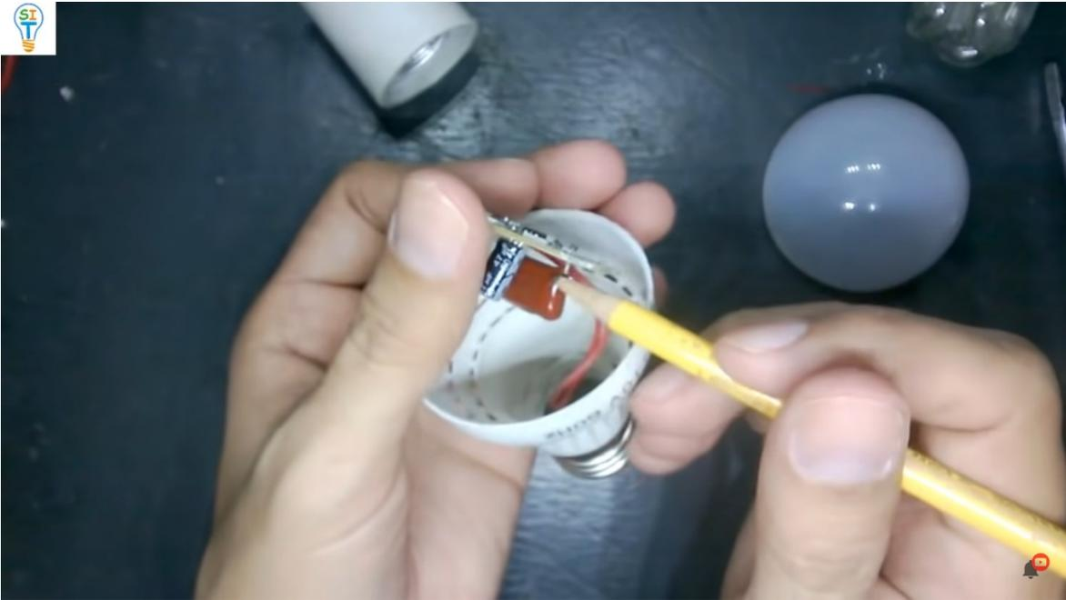
Si miramos la placa aquí te damos todos los elementos tenemos el capacitor que no es polarizado y el capacitor polarizado
