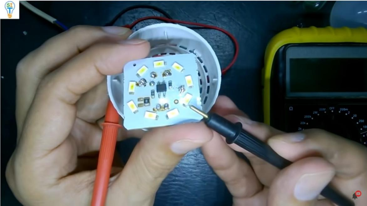
entonces si multiplicamos 3 por 4 nos da 12 voltios, entonces apilamos estos leds de 4 en teoría deberíamos poderlo alimentar con 12 Voltios.
