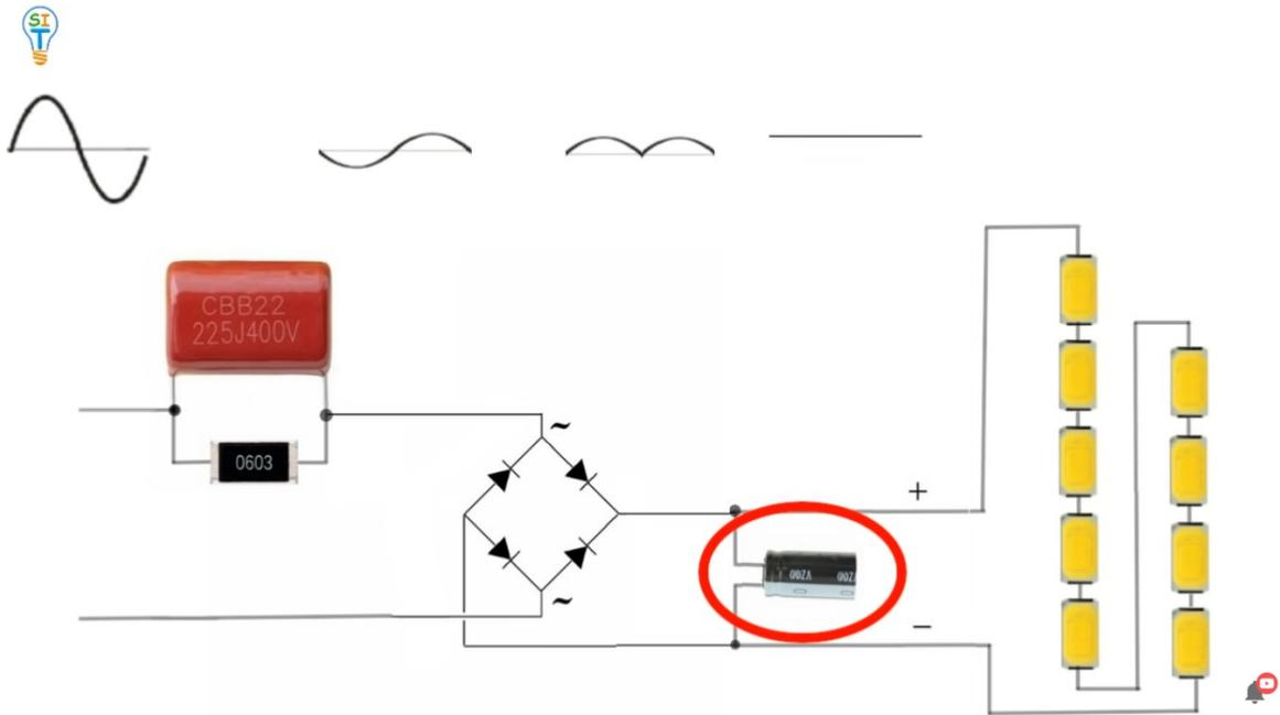
porque no está colocado en serie, sino en paralelo el primer capacitor estaba colocado en serie porque la función era muy diferente y el capacitor de filtrado que si es polarizado lo que hace es filtrar
