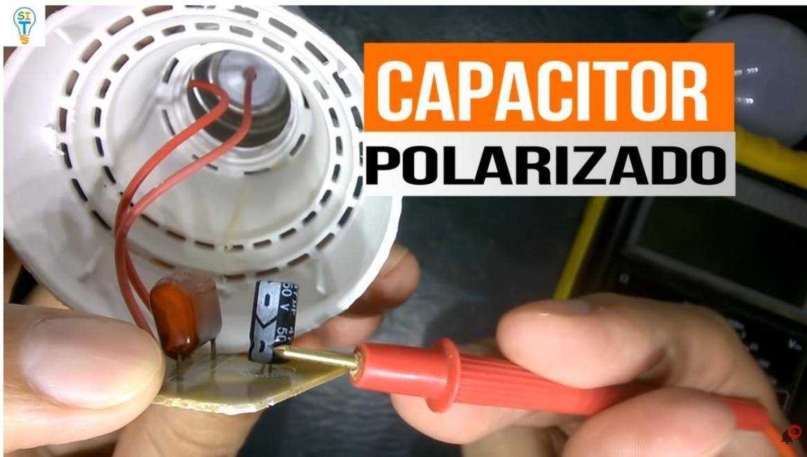
va justamente en paralelo con los leds en estos dos puntos
