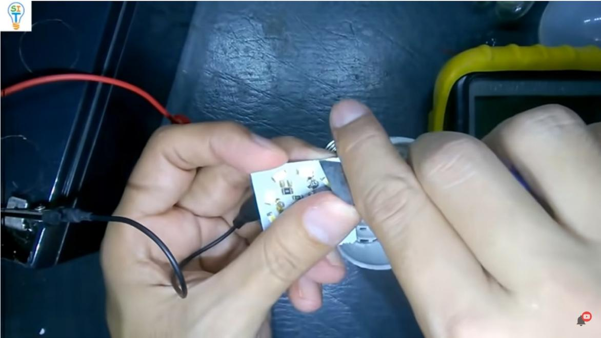
ok entonces ahora voy a conectar el positivo con el positivo del capacitor y el negativo en este punto de acá que es el cátodo del cuarto diodo
