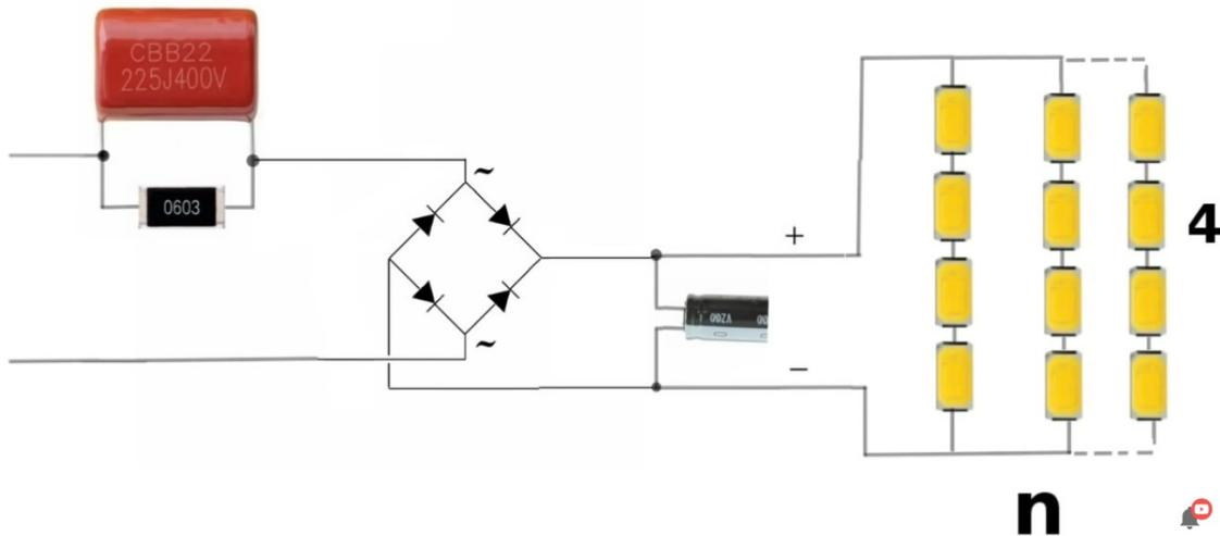
Te dejare otro diagrama simplemente agregando más líneas en paralelo de cuatro leds y de esa manera pueden trabajar con cualquier lámpara de cualquier tamaño y de cualquier cantidad de leds aplicando el mismo método que yo hice con esta lámpara y ustedes me dirán. Bueno, pero si yo coloco más leds entonces consume más.
