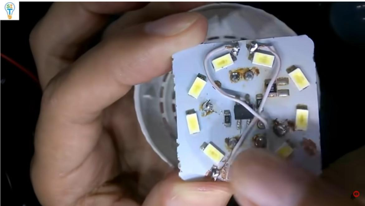
Como pueden ver ya realice los puentes de ambos lados derecho con izquierdo en paralelo, puedes guiarte por el capacitor que es la referencia para nosotros.
