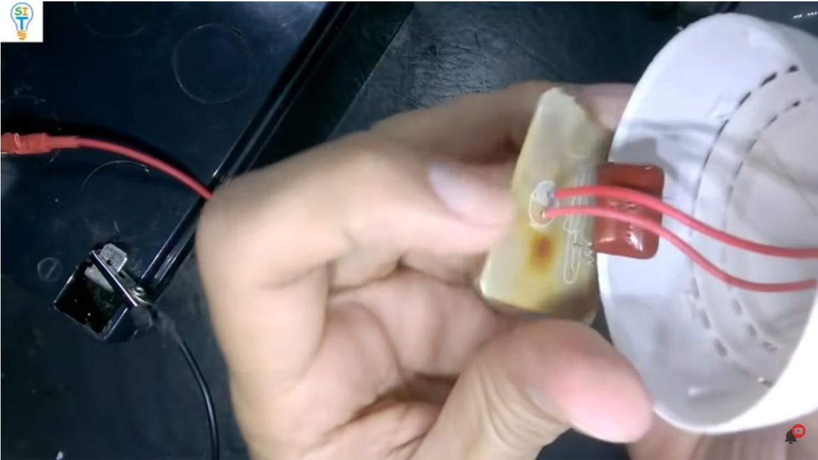
Ya saqué el capacitor y sustituí el cable de alimentación, lo coloqué directo acá donde estaba el capacitor electrolito
