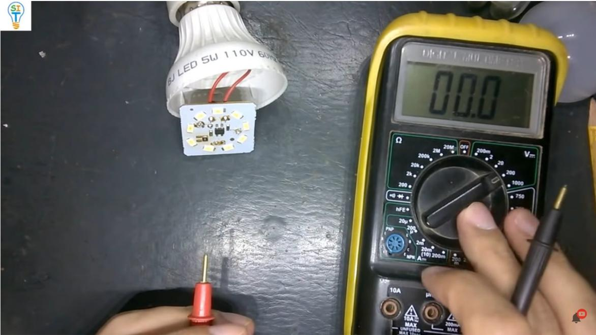
porque se supone que el valor debería estar por encima de 20 voltios si lo pongo en 20 voltios entonces se va a quedar corto el rango bueno y voy a tocar estos dos puntos
