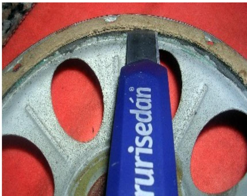
Es común que queden restos de pegamento en el borde donde estaban pegado el cono y el aro, estos restos hay que eliminarlos mediante el uso del cúter haciendo pasar la cuchilla del cúter con un ángulo tal que elimine totalmente los restos de pegamento.
