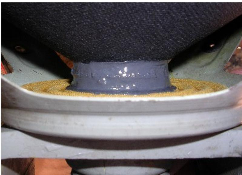
Hay que dejar que el cono quede en su posición correcta antes de que seque el pegamento. La posición correcta la verificamos observando la suspensión del mismo, pues ésta debe estar totalmente horizontal, es decir con ángulo  $0^\circ$ , sin estar estirada hacia arriba o hacia abajo. No siempre la parte inferior del cono queda tocando con la araña, hay veces que hay que dejar un pequeño cuello formado por la bobina; es decir que tendremos: araña – espacio donde se ve la bobina – base del cono.
