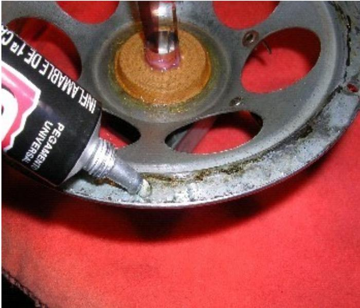
Una vez terminada la colocación en toda la vuelta apoyamos el cono y enseguida colocamos el aro dejando el parlante boca abajo y ejerciendo presión sobre el imán para que quede bien pegada la suspensión del cono a la campana y a su vez el aro contra la suspensión. En esta parte del trabajo el cono aún no está pegado con la bobina.
