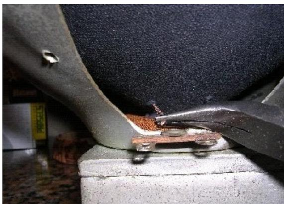
La colilla se deberá cortar de manera tal que quede un sobrante formando una panza en el interior del parlante, recuerden que el parlante se mueve hacia delante y hacia atrás con lo
