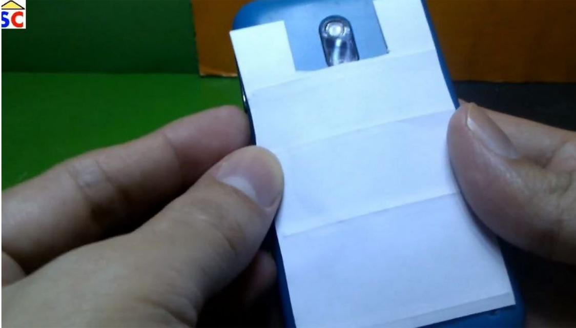
Este modelo de antena se podría colocar por fuera pero para mejorar la estética se puede retirar la tapa del teléfono y colocarlo por dentro para que no interfiera ni se vea y volvemos a colocar la tapa al teléfono y lo ajustamos.
