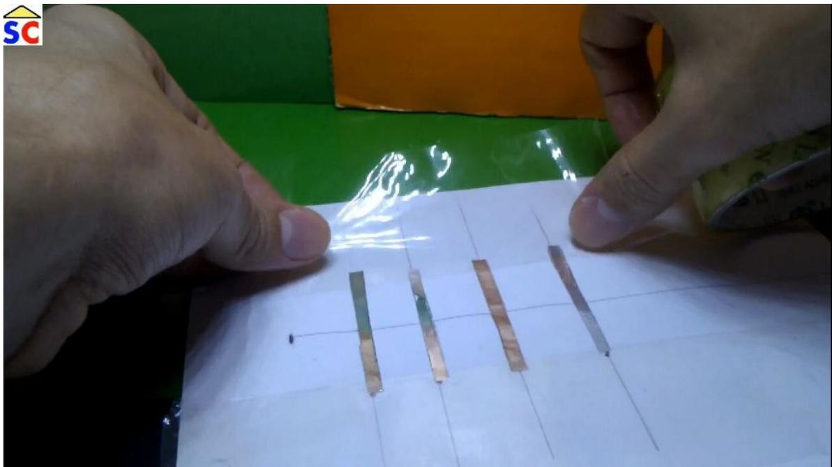
Al tener listo el dibujo se procederá a cortar el papel de aluminio con la medida de 3mm de ancho por lo largo que se necesite dependiendo del director y se pegan con cinta adhesiva en el dibujo.
