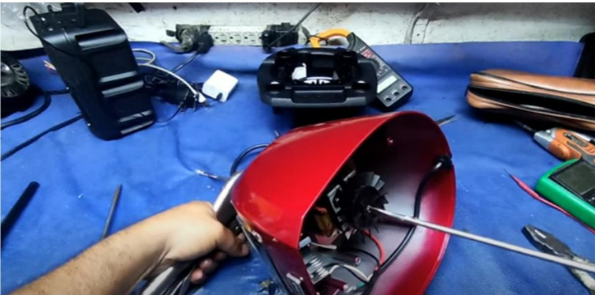
Desarmamos y sacamos el motor con un destornillador sosteniendo con un alicate de presión el cuadrante y le doy aquí en la pura Cruz del motor y vamos a girar esta pieza en sentido horario y del otro lado en sentido anti horario , quitamos los tornillos, hay que tener cuidado con esta hélice y aspa porque ahí está las aspas enfrían al motor, también abajo lleva un imán que es el que hace que detecte las revoluciones y no se va a detenga el motor
