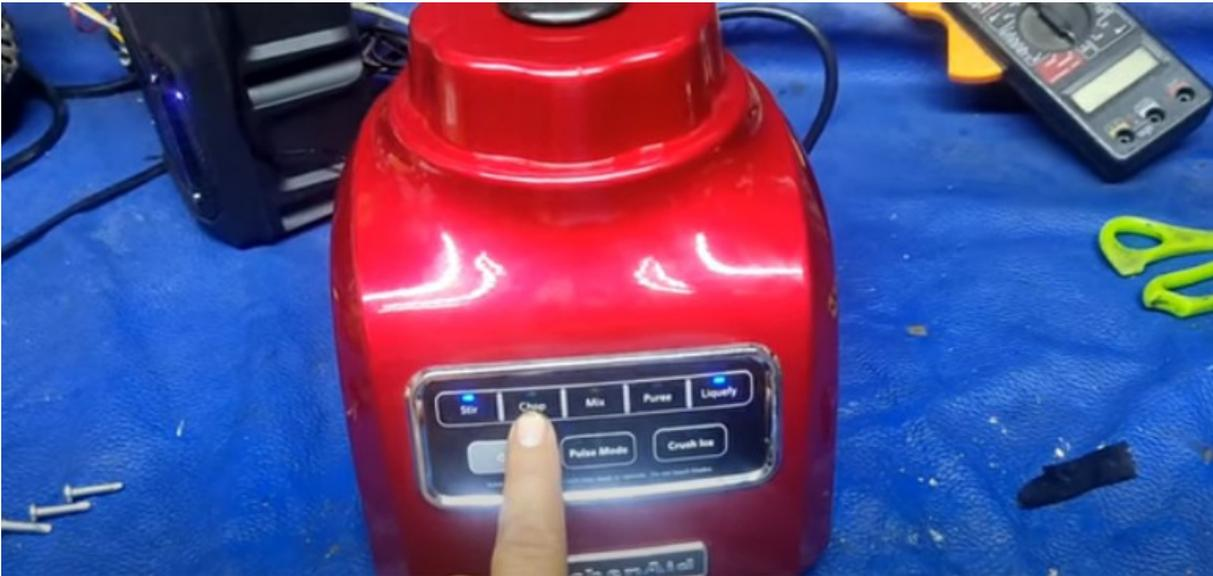
Tenemos Una licuadora de la marca kitchen light, que no funciona vamos a presionar cualquier opción y observamos que titilan los led azules y si se queda con las fallas , presiono otras teclas y observo que la licuadora no enciende
