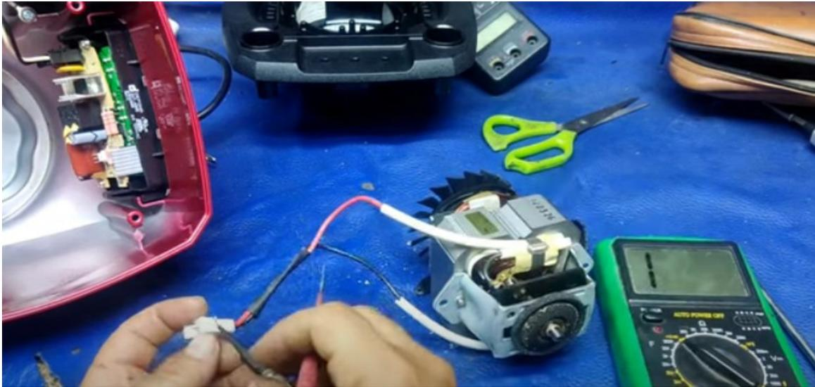
De este motor salen estos dos cables vamos a checar la continuidad a ver si no está abierta alguna bobina o el fusible del motor ,tocamos el cable rojo y no tenemos ninguna respuesta, tocamos el negro y si tenemos respuesta Esto significa que el motor está averiado, debido probablemente el exceso de uso se calentó mucho y se reventó el fusible
