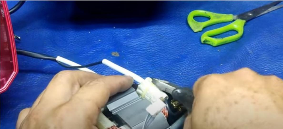
Buscamos un fusible al chequear la continuidad podemos observar que va al cable rojo . Cortamos las envolturas con una pinza y con un exacto para localizar el fusible por lo general a la bobina esta cerca de la bobina , vamos a romper de este lado ahora donde lleva unos cinchos, seguimos rompiendo , siguiendo el cable rojo hasta localizar el fusible
