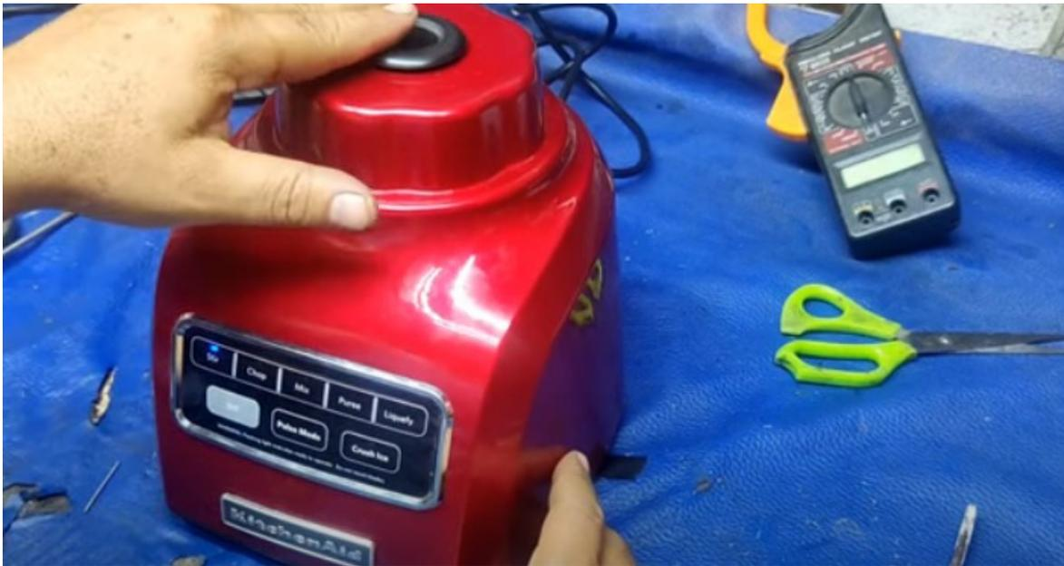
Comenzamos armar la licuadora le conectamos corriente vamos tecleando cualquier velocidad y observamos que funciona, verificando su funcionamiento
